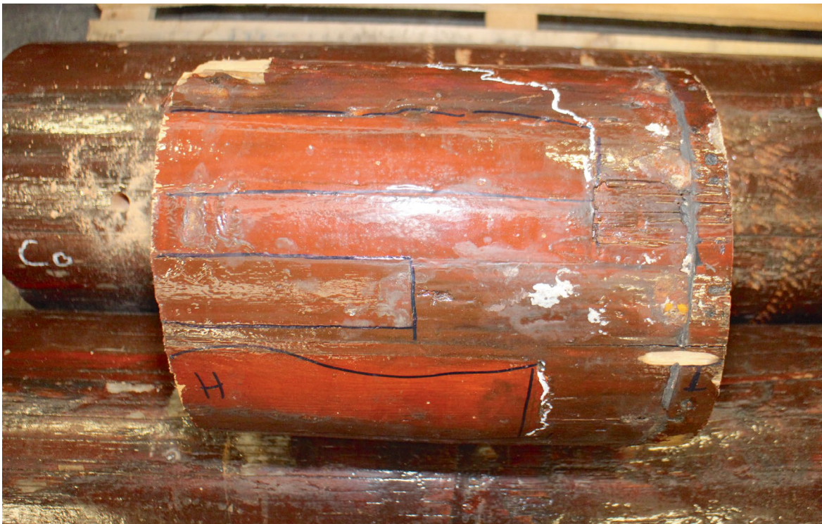
Figuur 46: Zijaanzicht van de ingelijmde latten. Foto: Onderzoeksraad voor Veiligheid
