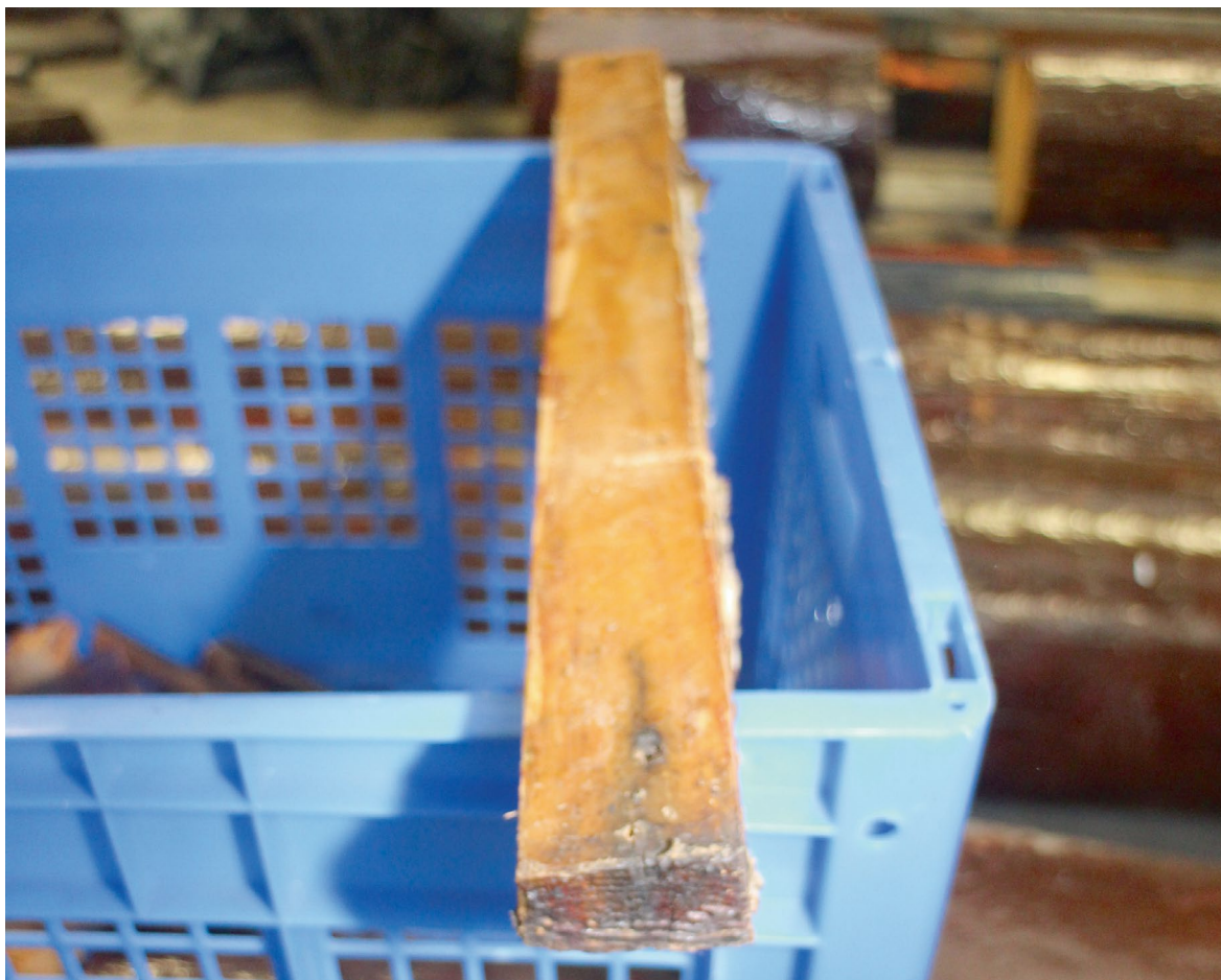
Figuur 47: Een van de vullatten die bij de reparatie is gebruikt. Foto: Onderzoeksraad voor Veiligheid
