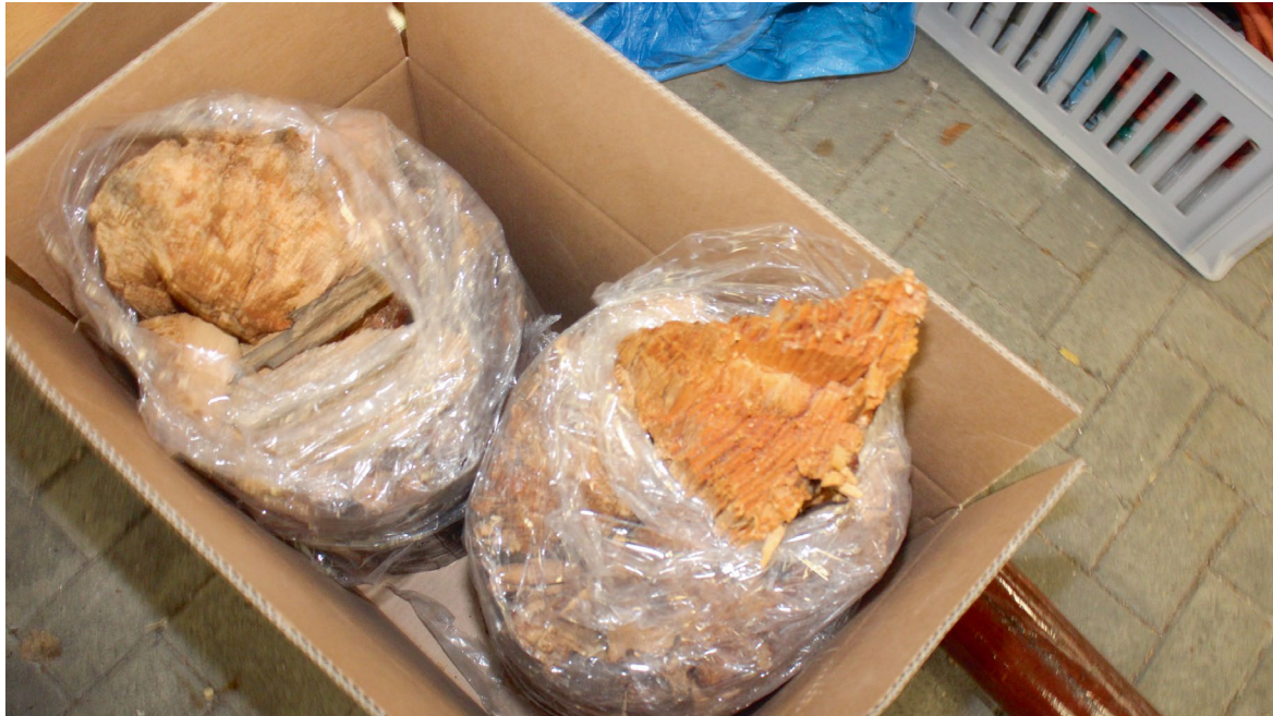
Figuur 41: Breukvlak met aangetast hout. Foto: Onderzoeksraad voor Veiligheid
