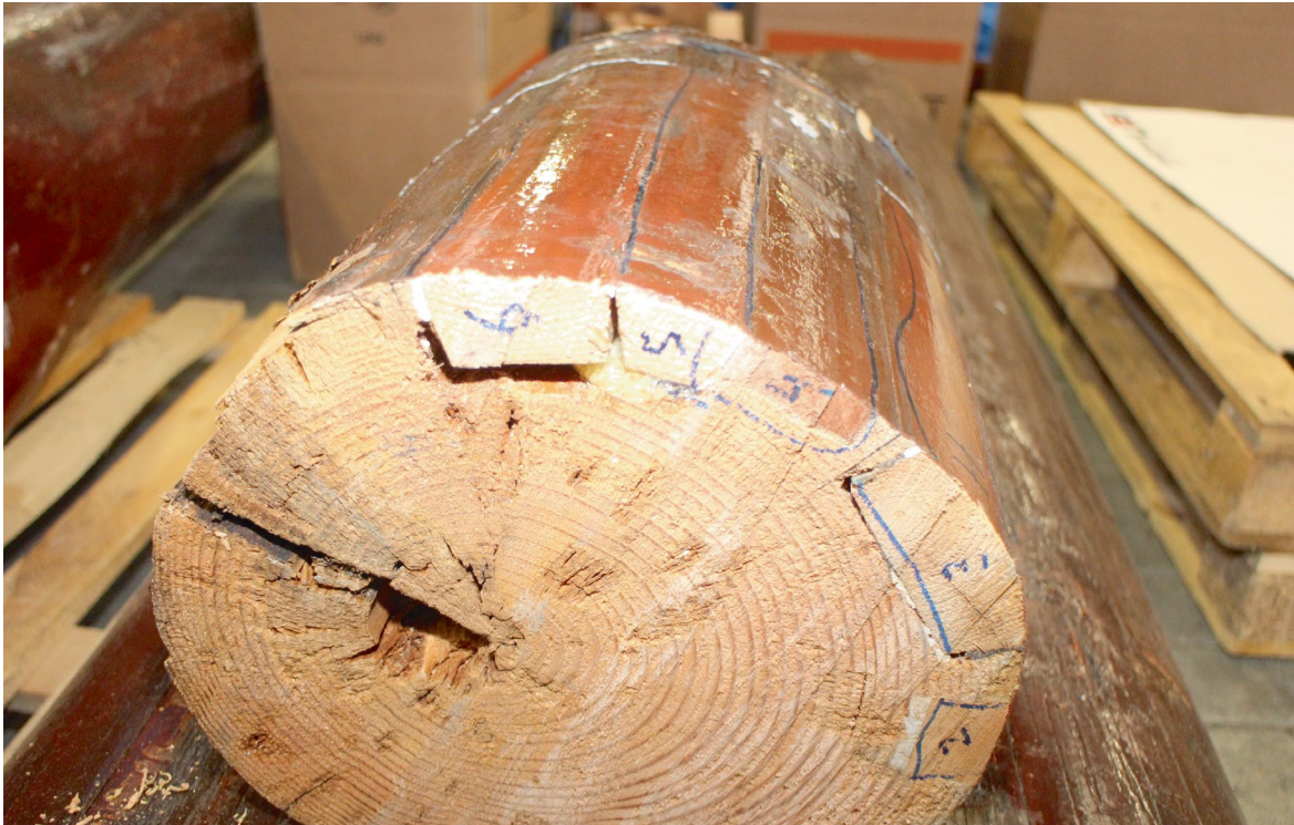
Figuur 45: Dwarsdoorsnede met ingelijmde latten en windscheuren achter gaffelplaat. Foto: Onderzoeksraad voor Veiligheid
