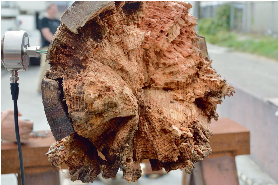
Figuur 37: Breukvlak van de mast. Foto: Politie
