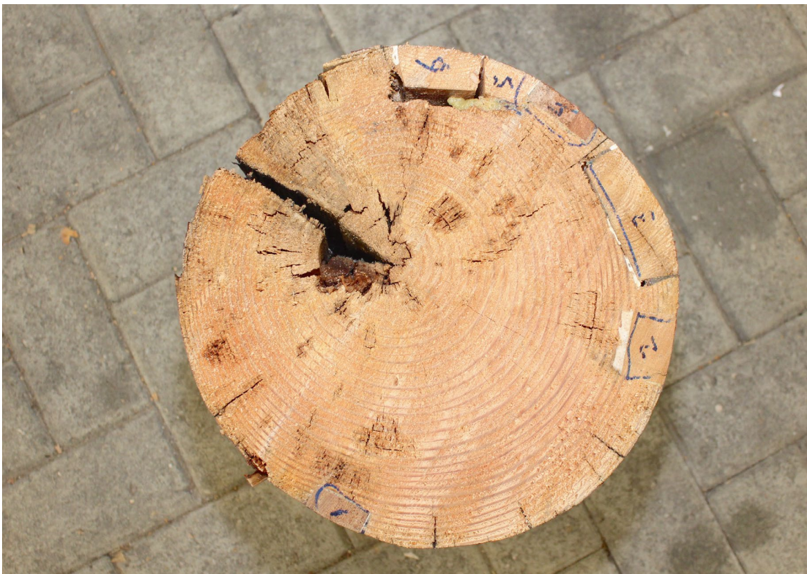
Figuur 44: Dwarsdoorsnede nabij het breukvlak. Foto: Onderzoeksraad voor Veiligheid
