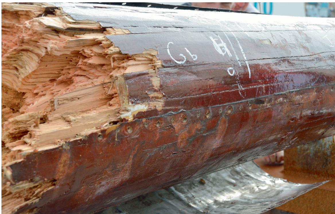
Figuur 40: Aanzicht van de mast onder de gaffelplaat. Foto: Politie
