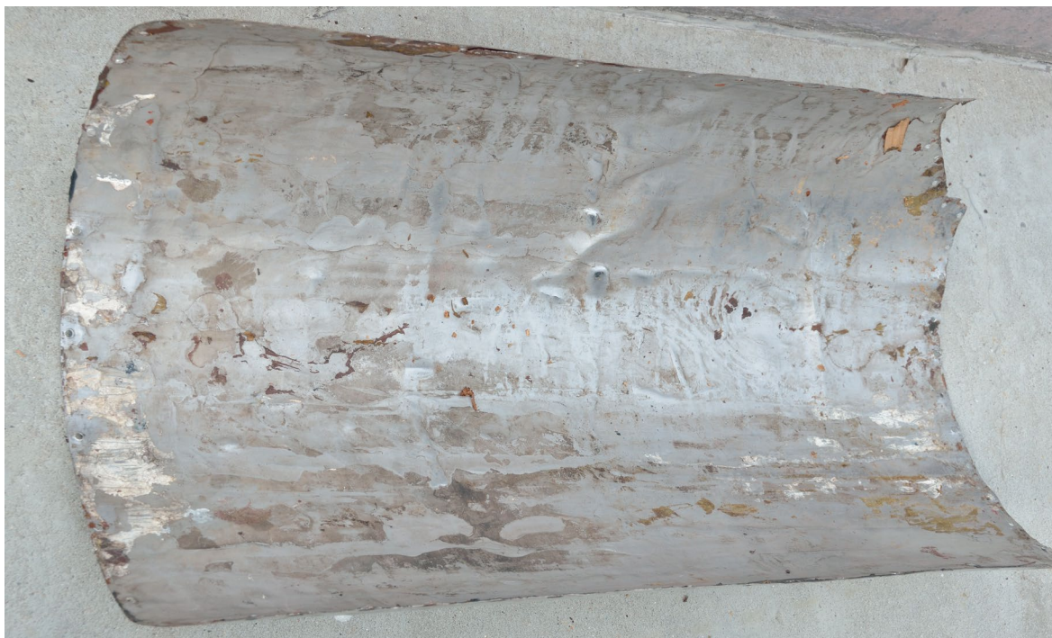
Figuur 14: Binnenkant gaffelplaat met uitgeharde lijmresten. Bron: Onderzoeksraad voor Veiligheid
