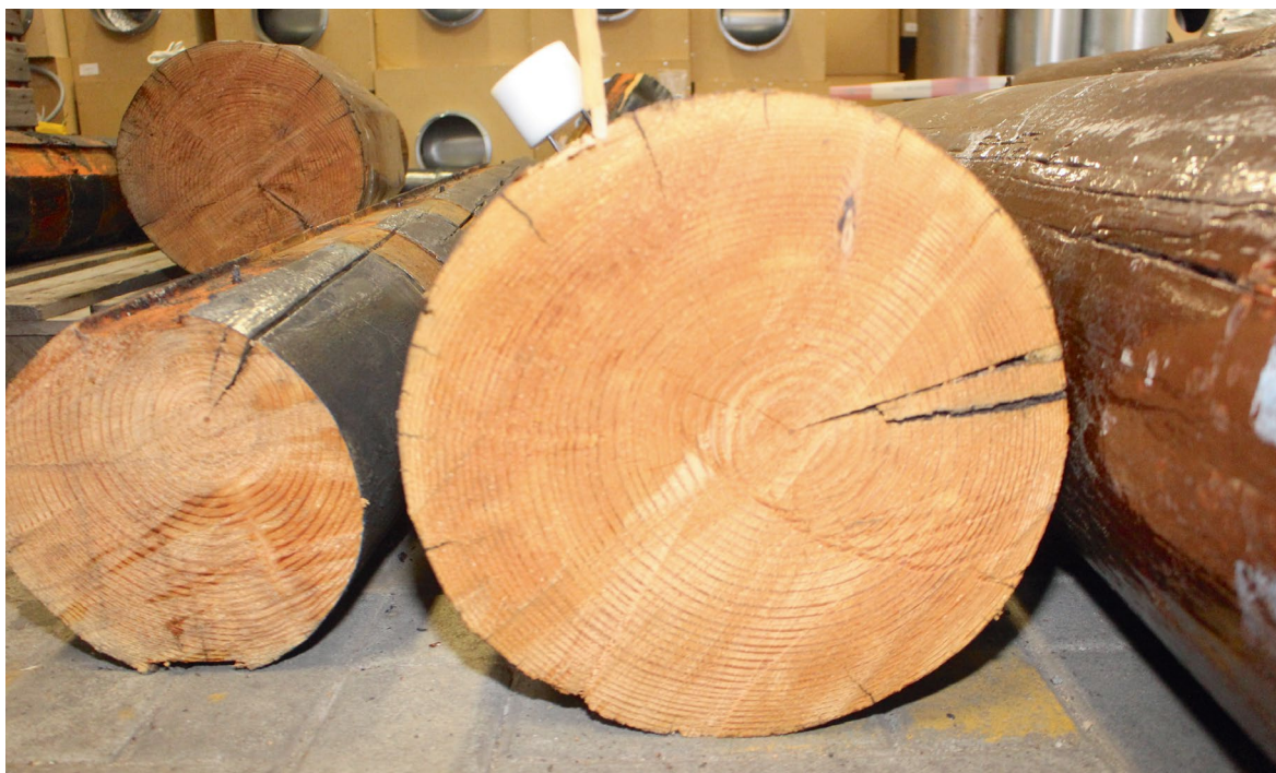
Figuur 48: Goed zichtbaar is dat de grote windscheur rechts tot in het hart van de mast doorloopt. Foto: Onderzoeksraad voor Veiligheid
