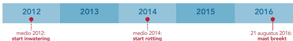
Figuur 9: Tijdlijn van het voortschrijdende rottingsproces.
