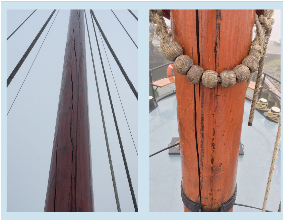
Figuur 17: Houten mast met windscheuren. Bron: Onderzoeksraad voor Veiligheid
