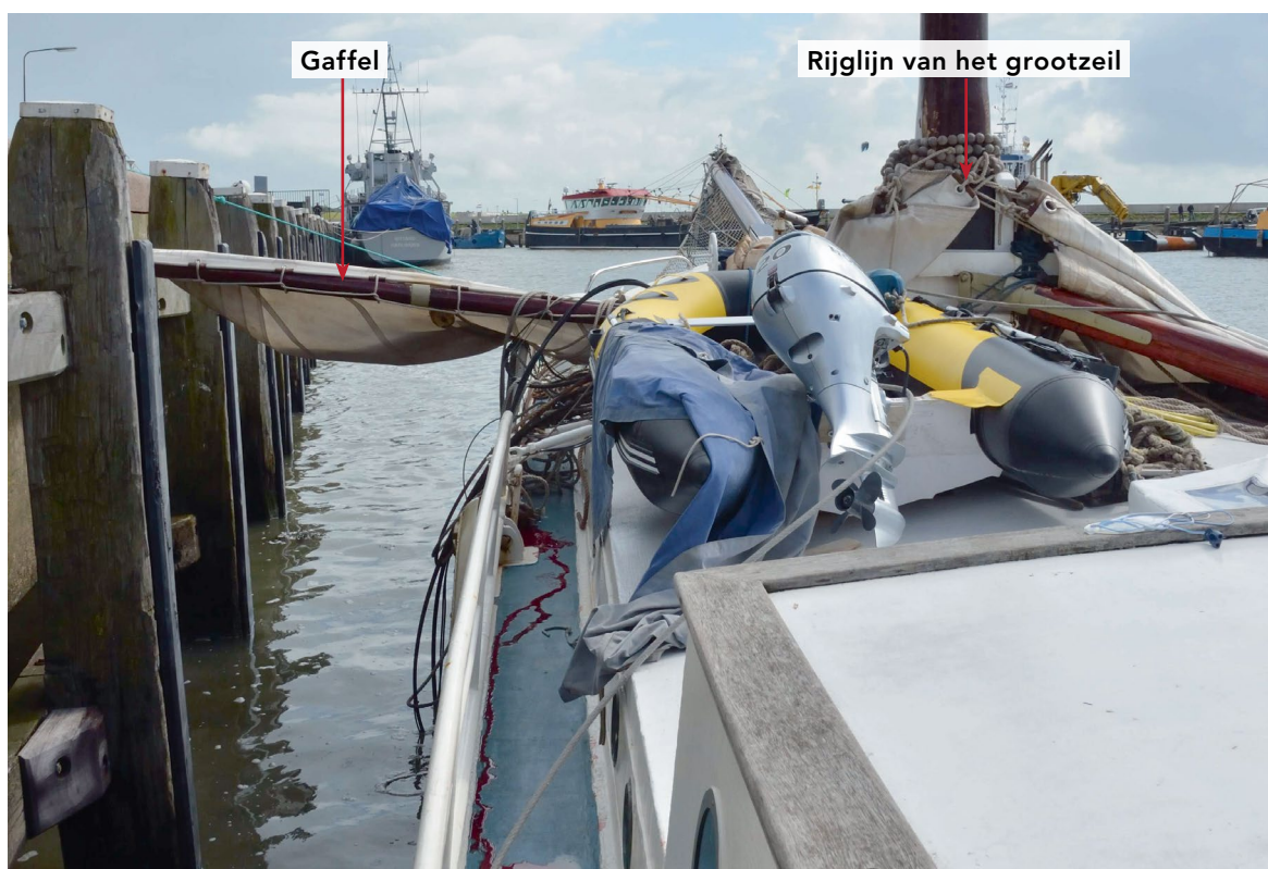
Figuur 27: Schadebeeld Amicitia bakboordzijde. Bron: Politie
