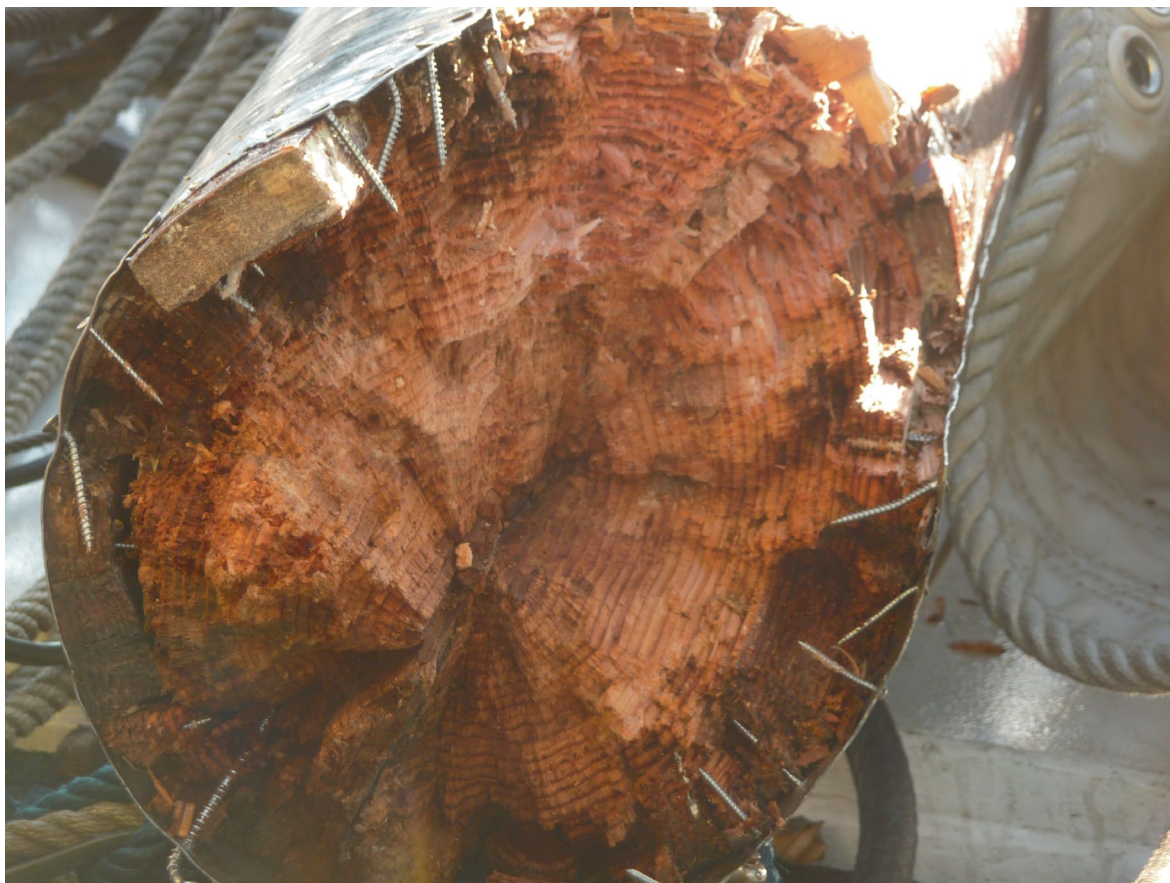
Figuur 6: Breukvlak en aantastingssporen. Bron: Onderzoeksraad voor Veiligheid
